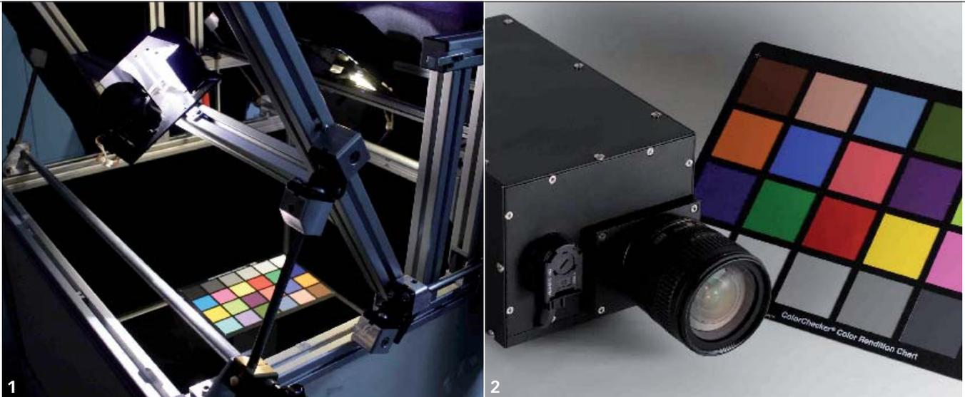
1 Der Aufnahmezustand des Versuchsaufbaus der RWTH Aachen besteht aus Profilen der Baureihe 8 von Item. Diese ermöglichen eine sehr flexible Konstruktion.
